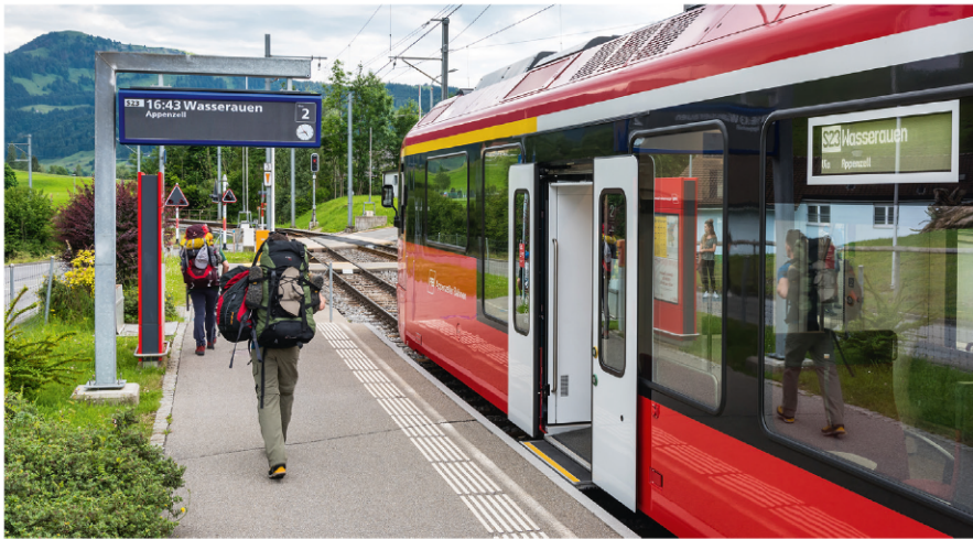
Bei der Appenzeller Bahnen AG steuert das zentrale System »DiLoc|Motion« sowohl die stationäre als auch die mobile Fahrgastinformation im Fahrzeug und versorgt die Fahrgäste mit Live-Informationen. Bilder: H. Krille
